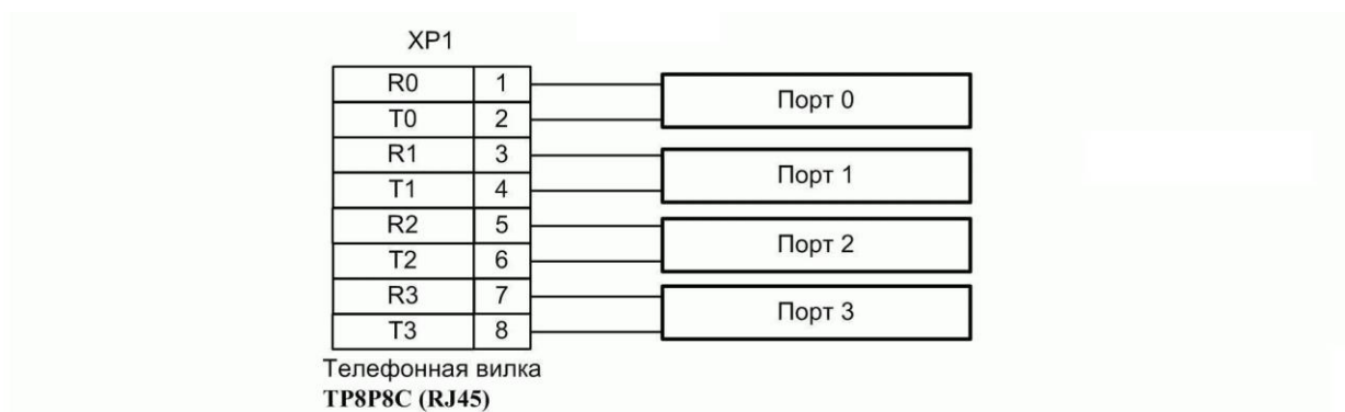
Рис. 30. Схема кабеля для подключения оконечных абонентских устройств к модулю DTB7-04
